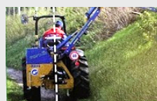
Attelage premier bras axe central du tracteur pour une plus grande stabilité
